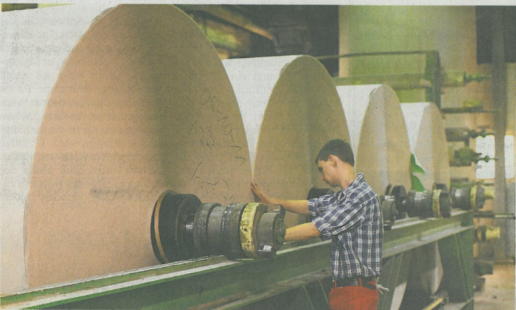
Schon fast fertig: Die Spindeln, auf denen das neue Papier aufgerollt wird, bilden einen der letzten Produktionsschritte.
